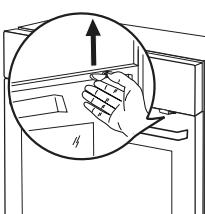
Zum Öffnen der Backofen-Tür mit aktivierter Kindersicherung ziehen Sie den Griff der Kindersicherung wie in der Abbildung gezeigt nach oben. Schliessen Sie dann die Backofentür, ohne an der Kindersicherung zu ziehen.
