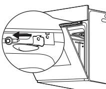
Zum Entfernen der Kindersicherung, öffnen Sie die Backofentür und entfernen Sie die Kindersicherung mit einem Torxschlüssel. Der Torxschlüssel befindet sich in der Einsparung.
