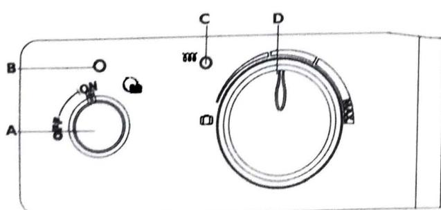
**A** Molette de sélection des modes et de Verrouillage des commandes.
